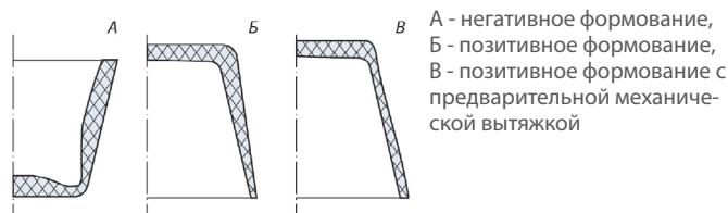
Рисунок 9. Примеры толщин стенок при различных видах формования
